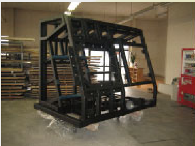
液晶関連装置フレーム（焼付け塗装）
